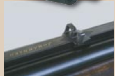
Das skelettierte Fluchtvisier bietet beste Übersicht und verdeckt das Ziel nicht.
