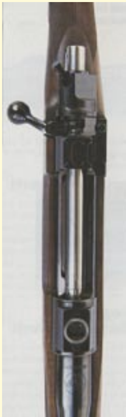
Die Verstärkungen an Hülsenbrücke und -kopf (Double-Square-Bridge) dienen als Montagefundament für Zielfernrohre.
